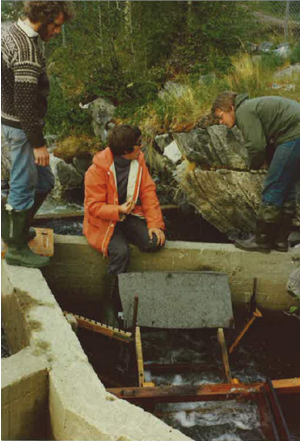
Valokuva 35. Kolttakönkääseen asetetun mekaanisen kalalaskurin, paikallisten nimittämän ”härvelin”, toiminnan tarkistus vuonna 1976. Kuvassa vasemmalla Arne B. Vaag, keskellä Vilhelm Bjerknes ja oikealla Pekka Tuunainen. Kuvaja tuntematon.
