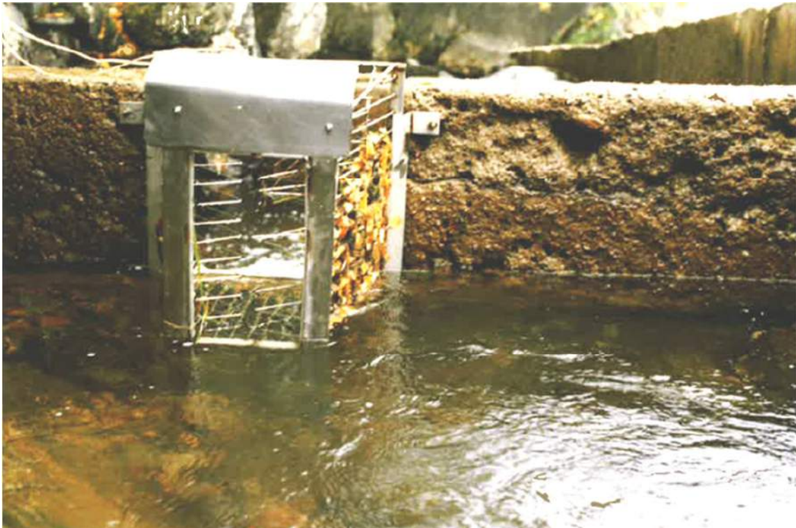
Valokuvat 39 ja 40. Vuonna 1996 lohimääriä laskettiin porrasaukkoon asetetulla mekaanisella laskurilla. Mekaanisen laskurin avautuviin metallisauvoihin tarttui ajelehtivää heinää ja puiden lehtiä, mikä häiritsi laskurin toimintaa. Ylempi kuva lohen noususuunnasta ylöspäin ja alempi kuva alavirtaa kohti. Valokuva Kjell Moen.
