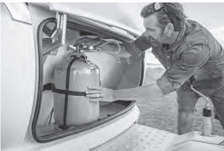
Kaasupullon sijoittaminen kaasupullokaappiin
