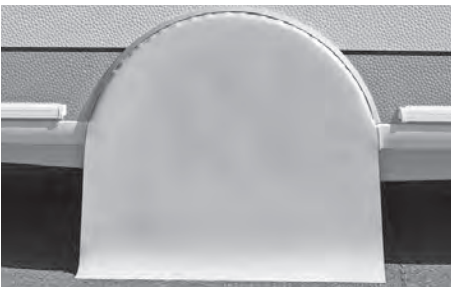
Pyöräkotelon suojukseen integroitu ura rengassuojalle
