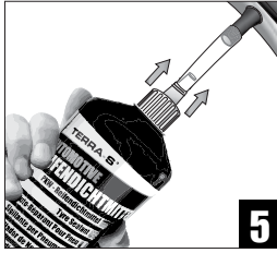
Työnnä täyttöletku rengasventtiiliin
