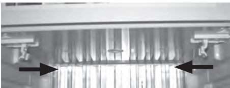
Pakastelokeron pohjan irrottaminen
